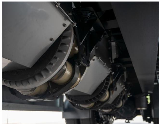
**Wirbelstrombremsen mit Luftführungen**
